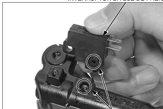
ALINHAR PARAFUSO INTERRUPTOR DA LUZ DE FREIO
